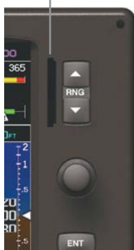
Display Bezel SD Card Slot
