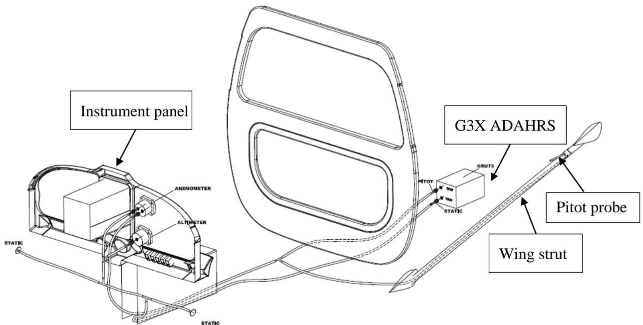
FIG.7-8. PITOT-STATIC SYSTEM
