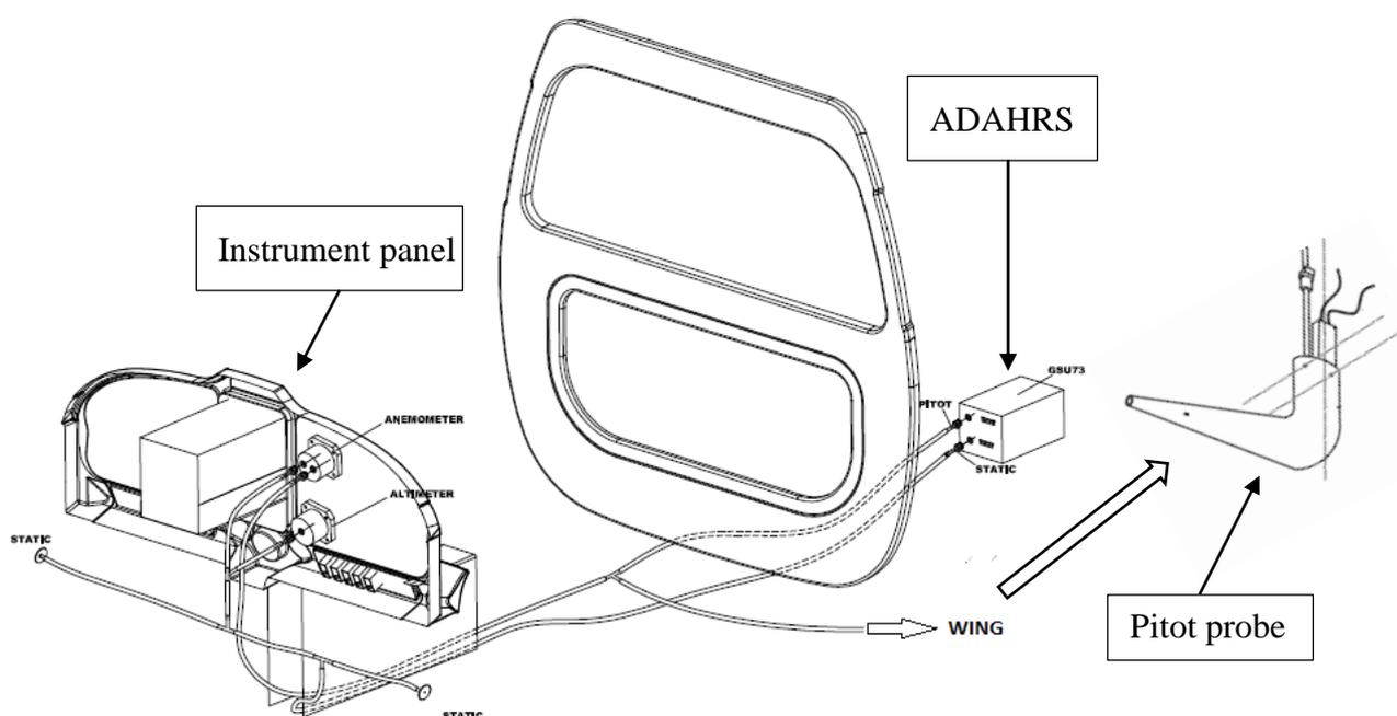
FIG.7-8. PITOT-STATIC SYSTEM
