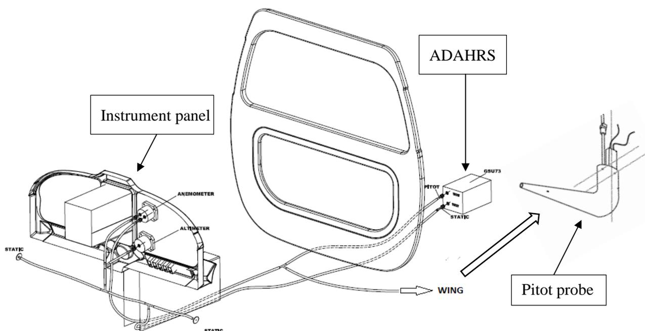
FIG.7-8. PITOT-STATIC SYSTEM
